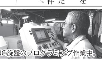
CNC旋盤のプログラミング作業中。
